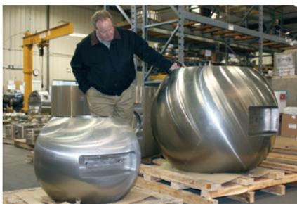
*Muchos factores deben tenerse en cuenta acerca del diseño de cada componente de la válvula antes de optar por simplemente agrandar una válvula de tamaño menor. Por ejemplo, este diámetro de 36 pulgadas es considerablemente mayor en relación con la bola de 24 pulgadas, mientras que las ranuras del vástago tienen diferentes proporciones debido a los requerimientos de desempeño.*
